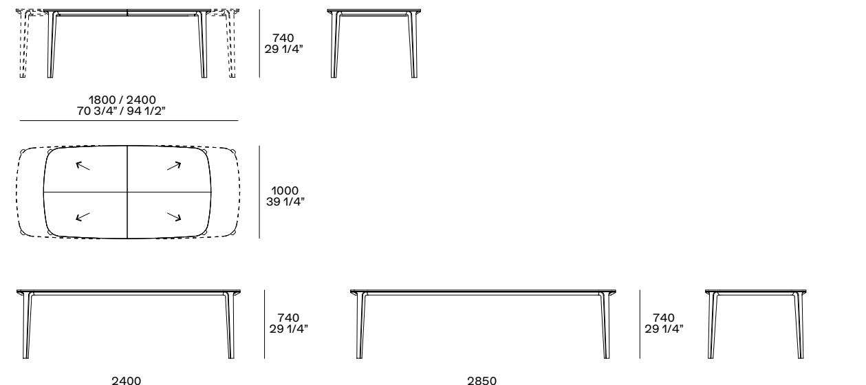
Le frecce indicano l'orientamento delle venature del legno.
