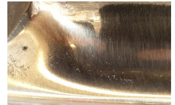
Dettaglio soffiatura del bronzo (e segni di pulitura)
