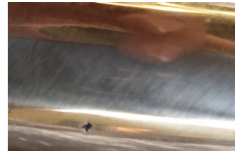
Dettaglio soffiatura del bronzo
