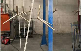
Preparazione delle gambe alla verniciatura
