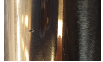
Esempio di soffiatura del bronzo
