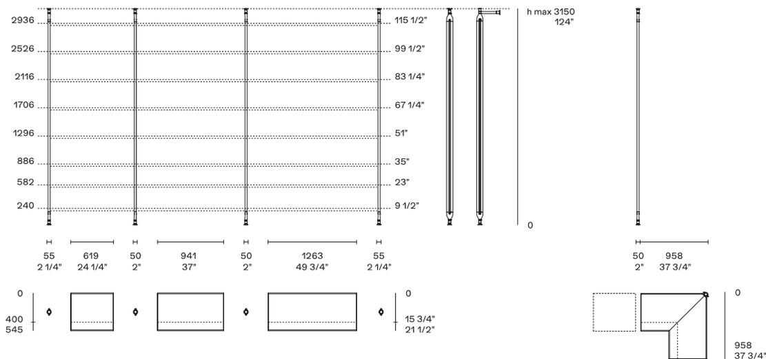
Um die Gesamtbreite zu erreichen, addieren Sie zur Summe der Regalenbreite 55 mm für den ersten Pfosten, 50 mm für jeden zentralen Pfosten und 55 mm für den Abschlusspfosten. Die Höhe des unteren Regals darf nicht weniger als 240 mm vom Boden entfernt sein, das obere Regal darf nicht weniger als 200 mm von der Decke oder dem Ende des Pfostens entfernt sein.
