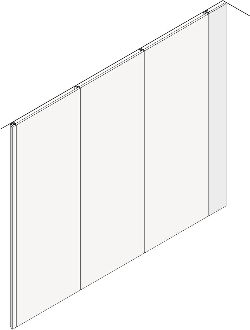
Fascia di aggiustaggio terminale a muro in sostituzione al profilo laterale. Fascia larghezza mm 300 riducibile fino a minimo mm 60.
